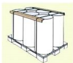
Kraštų apsauga ir rulonų tvirtinimas ant padėklo
